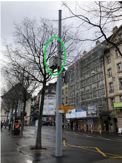
Seit Februar 2022 wird mit einem Dauer-Schallmesssystem der Tram-Lärm an der Schiffflände aufgenommen und ausgewertet. Es folgen verschiedene Tests mit dem Ziel, das zeitweise Quietschen zu reduzieren.
