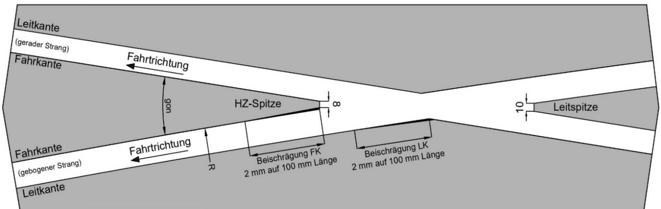
Abb. 13-3: Beispiel: Bearbeitung des einfachen Herzstücks bei R < 100 m und Winkel < 40 gon
