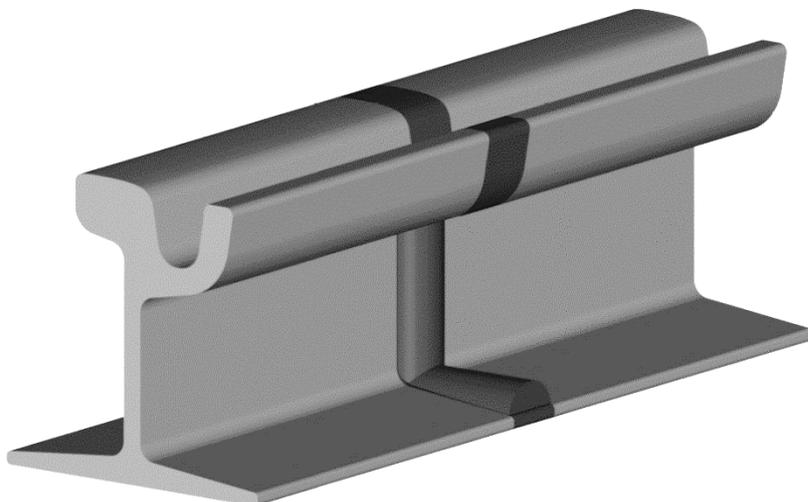
Abb. 26-1: Schweissstoss an Rillenschienen
