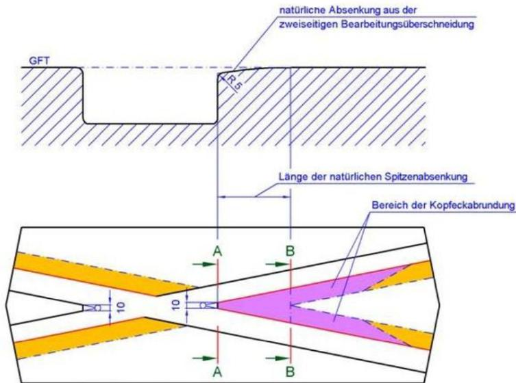
Abb. 12-1: Natürliche Absenkung aus der zweiseitigen Bearbeitungsüberschneidung
