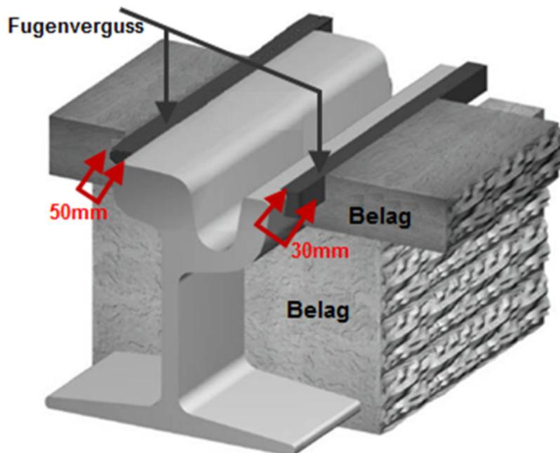
Abb. 02-1: Schienenquerschnitt mit Vergussfugen und Belag
