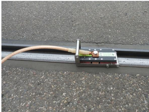
Diese Erdungsvariante besteht aus einem starken Schienenmagneten und dem dazugehörigen Kabel mit einem Querschnitt von 50 mm<sup>2</sup>.
