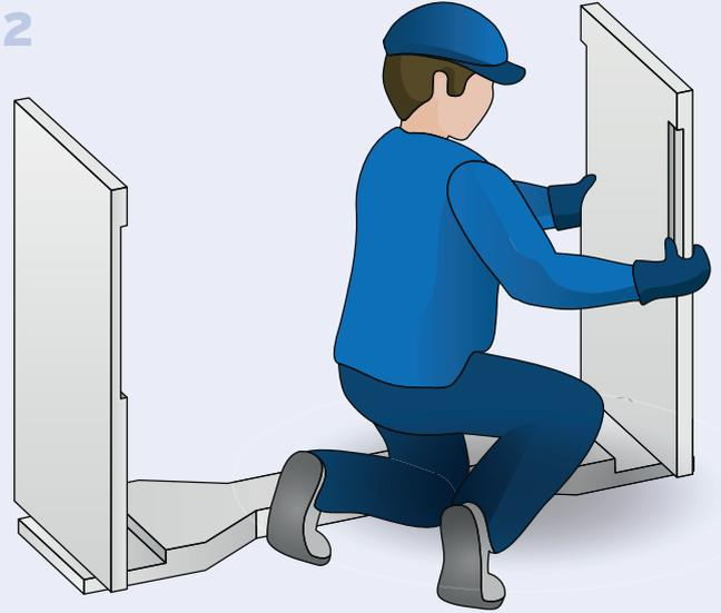
Die Seitenteile mit den Falzen nach oben auf die Grundplatte setzen.
