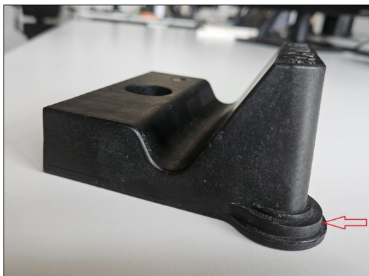
Abbildung 3: W-Tram Endstück mit Markierung an den Ecken zur korrekten Betoneinbauhöhe
