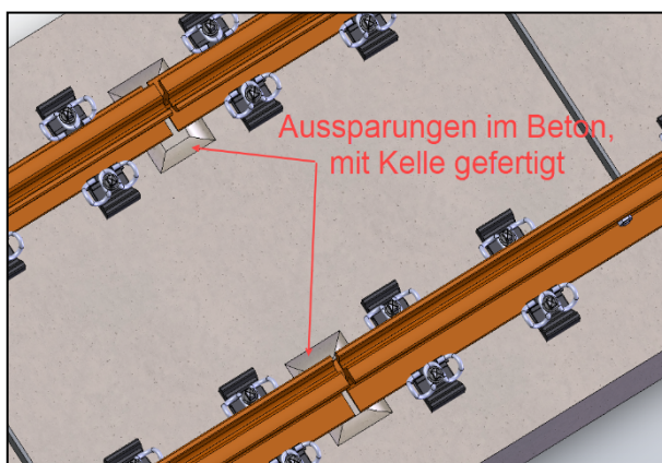
Abbildung 7: Übersicht der Aussparungen je Schienenstoss
