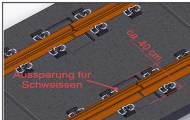
Abbildung 9: Übersicht der Aussparungen im Beton für das Thermitschweissen
