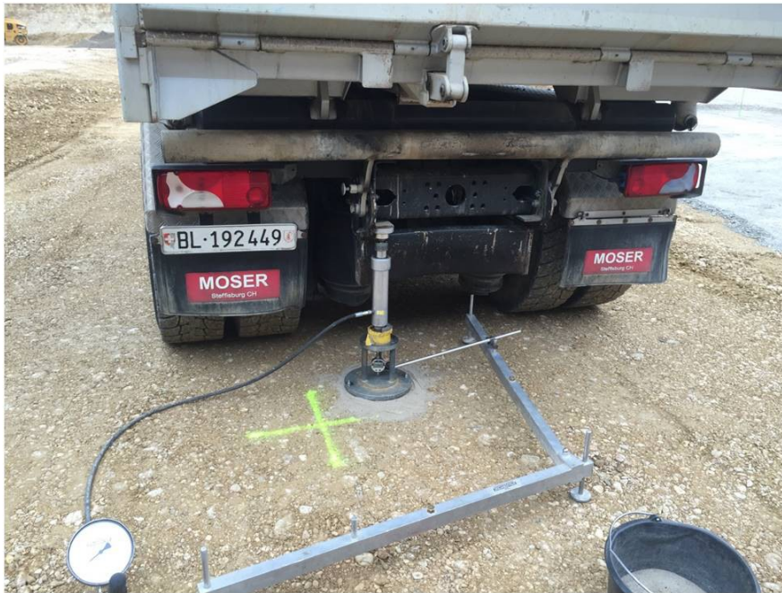
Abbildung 8: Plattendruckversuch für die vor Ort Bestimmung von M_E -Werten
