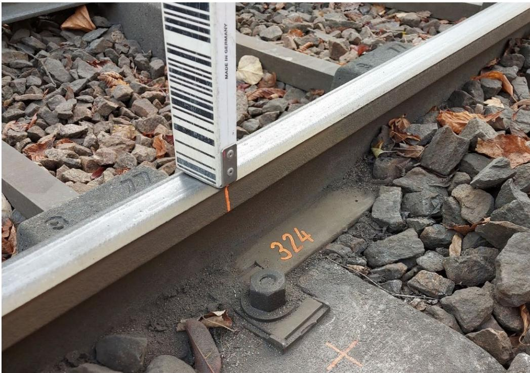
Abb. 19: Markierung des Messpunktes an der Außenkante der Fahrschiene.
