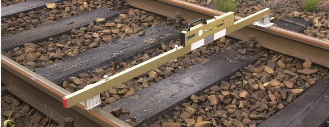
Abb. 9: Messung der Spurweite
