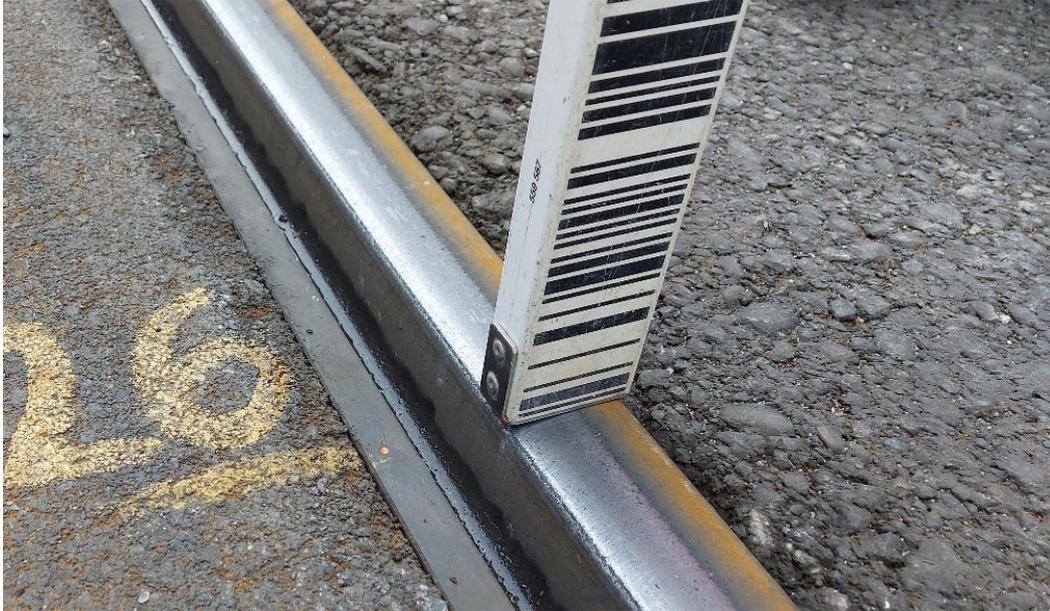
Abb. 20: Körnerloch auf dem Rillenkopf und Markierung auf dem Belag, Messung auf Fahrschienenkopf
