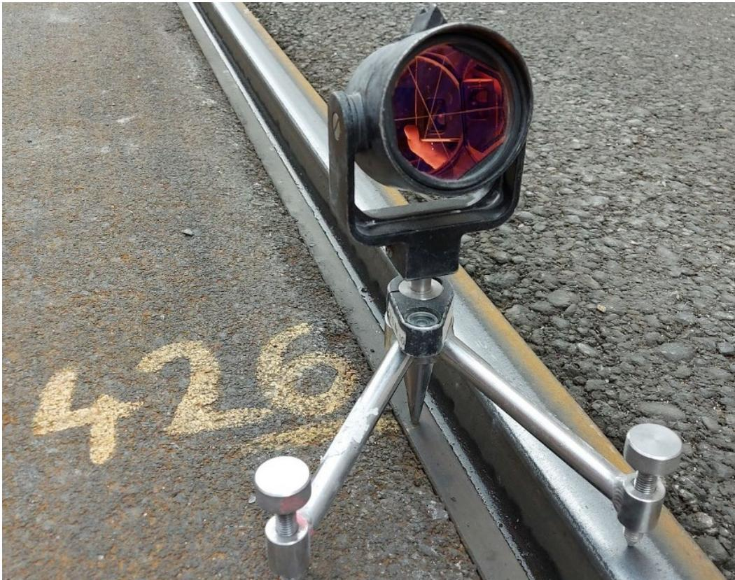
Abb. 22: Mini-Lotstock zentriert auf Körnerloch der Rillenschiene
