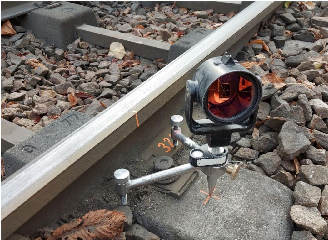
Abb. 21: Mini-Lotstock zentriert auf markiertem Messpunkt auf Gleisschwelle
