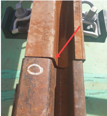
Abb. 12: Negativbeispiel mit unzulässigem, seitlichem Versatz (max. \pm 1 mm) an der Fahrkante
