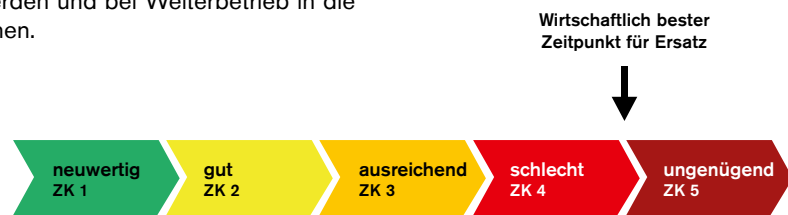
Abbildung 4: Zustandsklassen im Lebenszyklus einer Anlage
