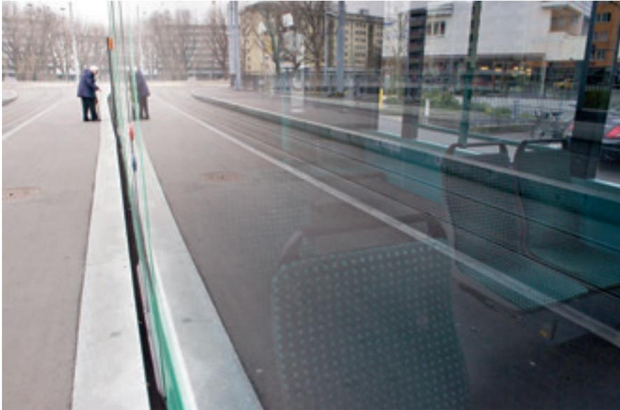
Nahtloser Übergang zwischen Fahrzeug und Haltekante: für mehr Komfort und Sicherheit beim Ein- und Aussteigen.
